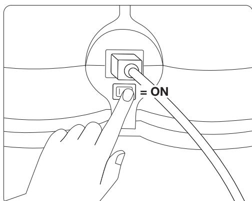
**MISE EN ROUTE DE L'APPAREIL · STARTING THE APPLIANCE · INBETRIEBNAHME DES GERÄTS
